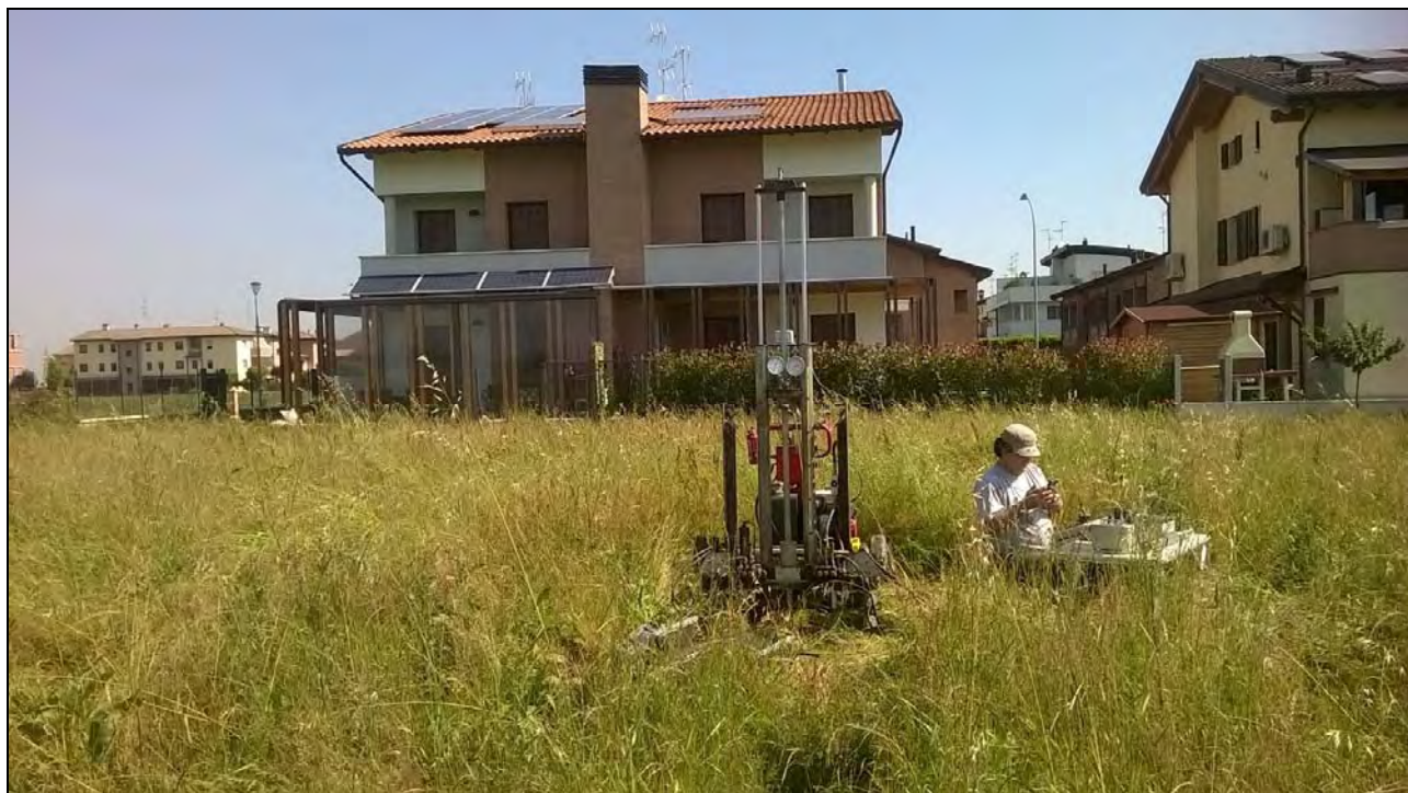
Immagine 2.8-2 Fase di esecuzione CPTU1
