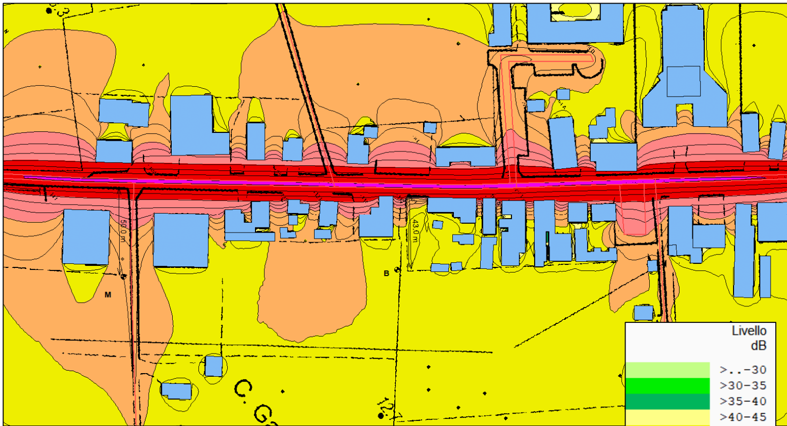
Immagine 10 - Modellazione con il software previsionale IMMI v. 2020 dello scenario allo stato di fatto: mappature diurna e notturna a 4 m dal p.c. del rumore STRADALE
