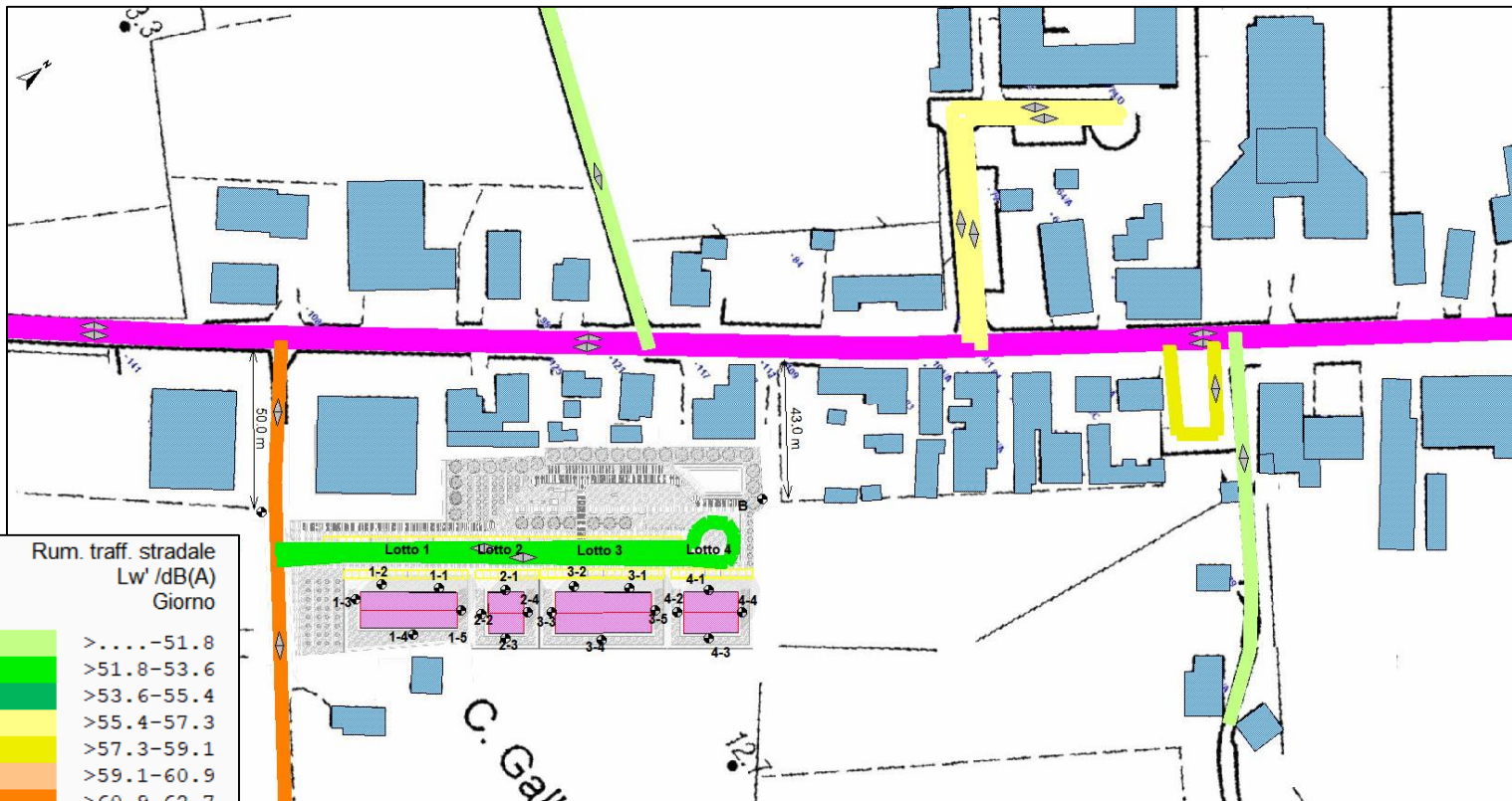
Immagine 11.2 – Livelli di potenza sonora allo stato di progetto delle arterie viarie sienite nel modello di calcolo IMMI vs. 2020
