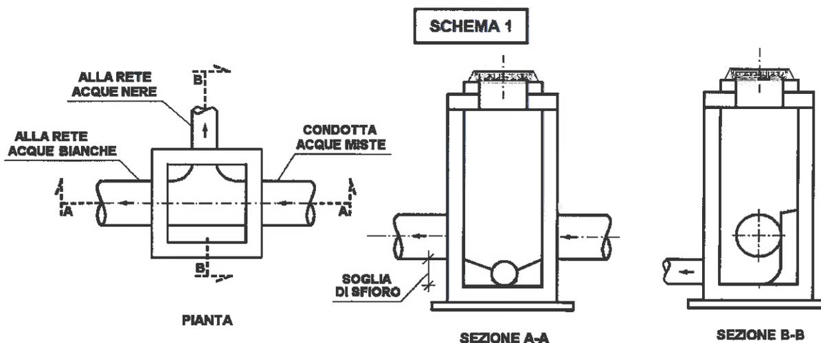
Figura 9: schemi realizzativi per scolmatore di rete mista.
