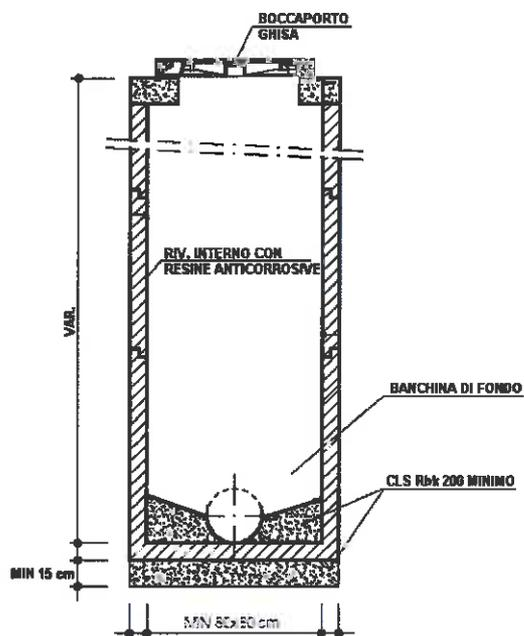
Figura 1: pozzetto d'ispezione.
