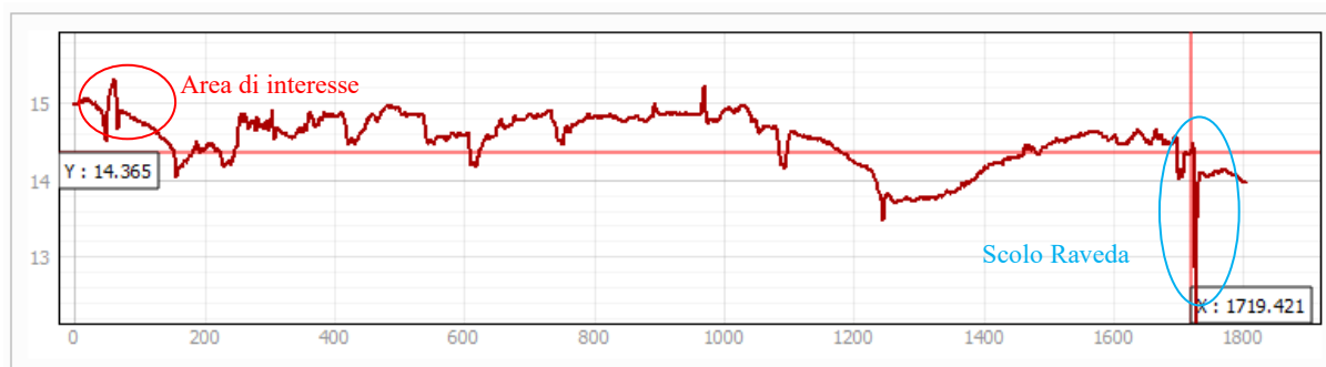
Figura 7 – Profilo del terreno in corrispondenza della sezione longitudinale tra l'area di interesse e lo scolo Raveda.
