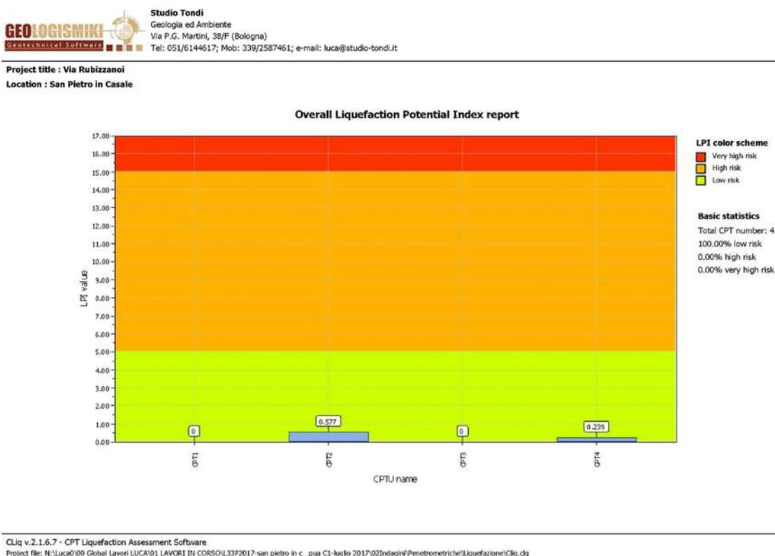
Figura 7: indice di potenziale liquefazione ( $I_L$ ), stimato nelle verticali di prova.
