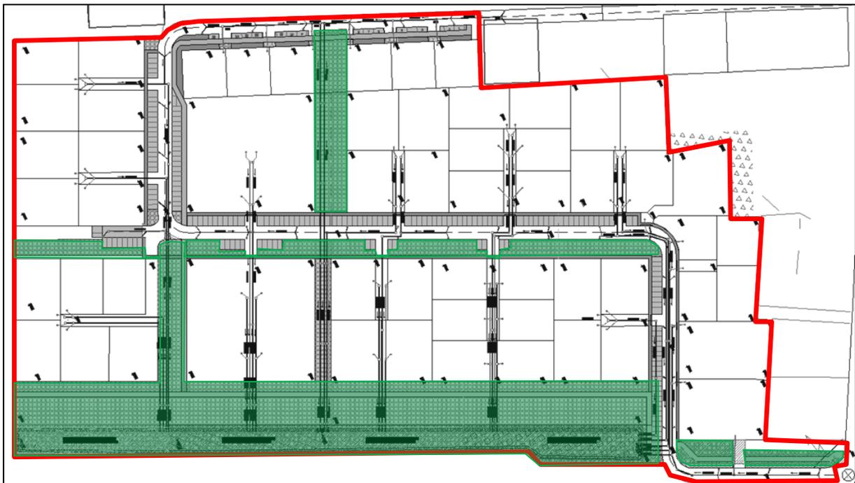
*Figura 8 – Rappresentazione della superficie complessiva con evidenziata l'area drenata utilizzata per il calcolo del volume di laminazione e il verde compatto stralciato dal calcolo.*
